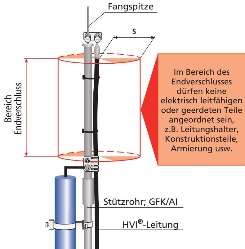
**Bild 1** Endverschluss am Stützrohr
